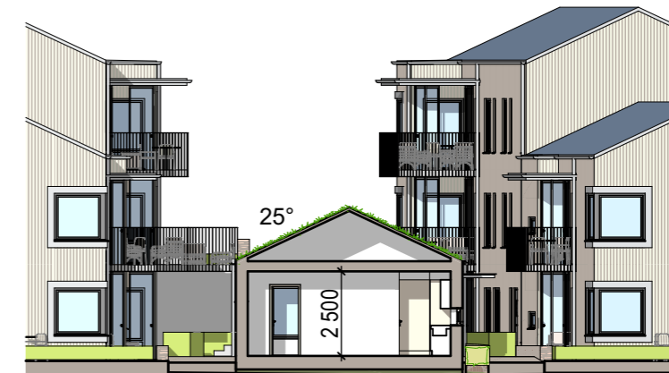
Sektion G-G - Övernattningslägenhet Skala 1:200
